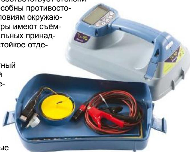
**Функция SideStepauto™:** возможность генератора рассчитать оптимальную частоту, основываясь на импедансе относительно земли. В генераторе эта информация используется для оптимизации активной частоты. Функция SideStepauto™ помогает повысить точность локализации и продлевает срок службы батареи питания.
